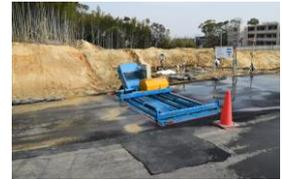
トラックの土砂洗車装置
