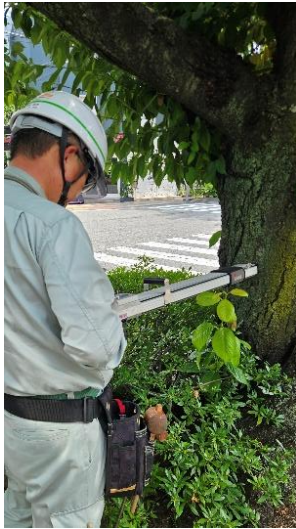
左) 長い棒の 先にある 針状物を 幹に挿入 して空洞 化状態を チェック
